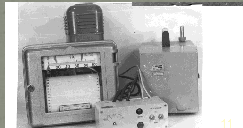
Кулонополярный газоанализатор на сернистый газ (ГКП-1) и диплом о награждении этого прибора золотой медалью Лейпцигской ярмарки.
