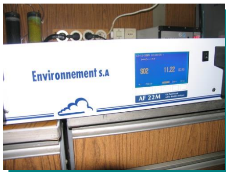
Ультрафиолетовый флуоресцентный анализатор AF 22M (измерение концентраций диоксида серы)
