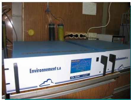
Ультрафиолетовый фотометрический анализатор O3 42M (измерение концентраций приземного озона)
