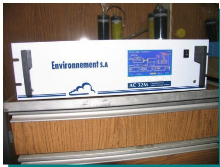
Хемилюминесцентный анализатор (измерение концентрации диоксида азота)
