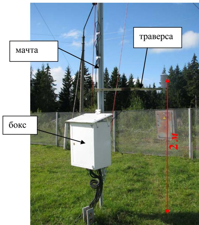
Рисунок 8.3 – Мачта АМК с установленной радиационной защитой датчика температуры и влажности
