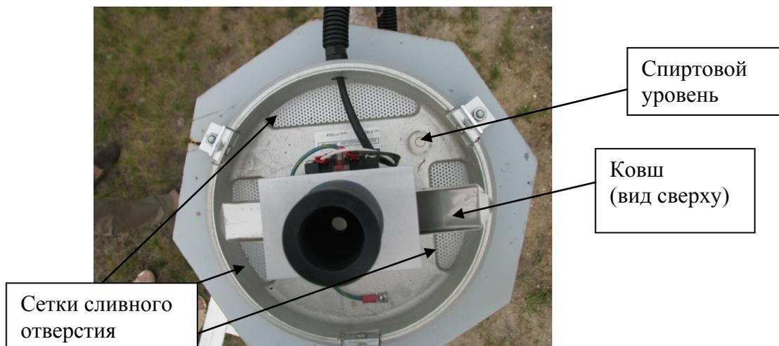
Рисунок 10.8 – Внутренняя конструкция ДЖО (вид сверху)
