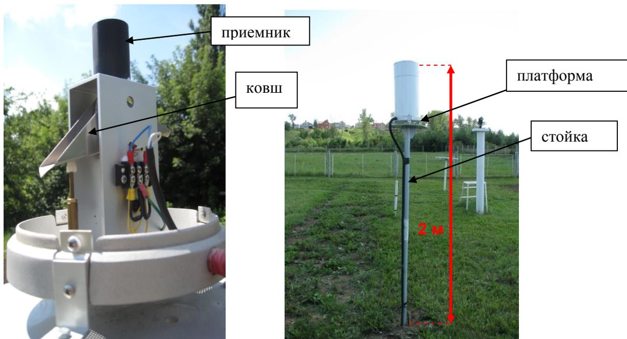
Рисунок 10.1 – Внутренняя конструкция ДЖО
