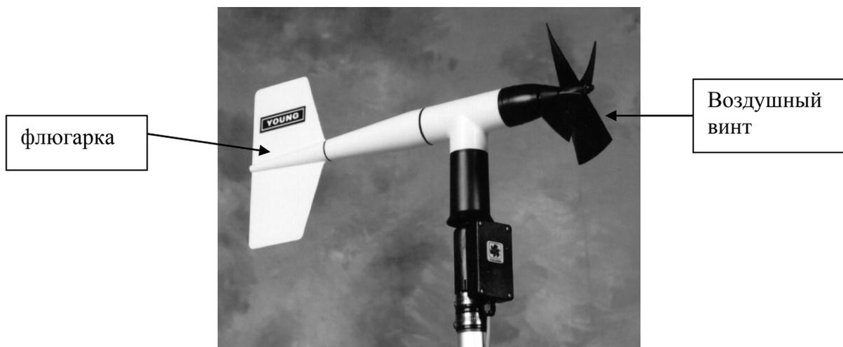
Рисунок 7.1 – Датчик скорости и направления ветра
