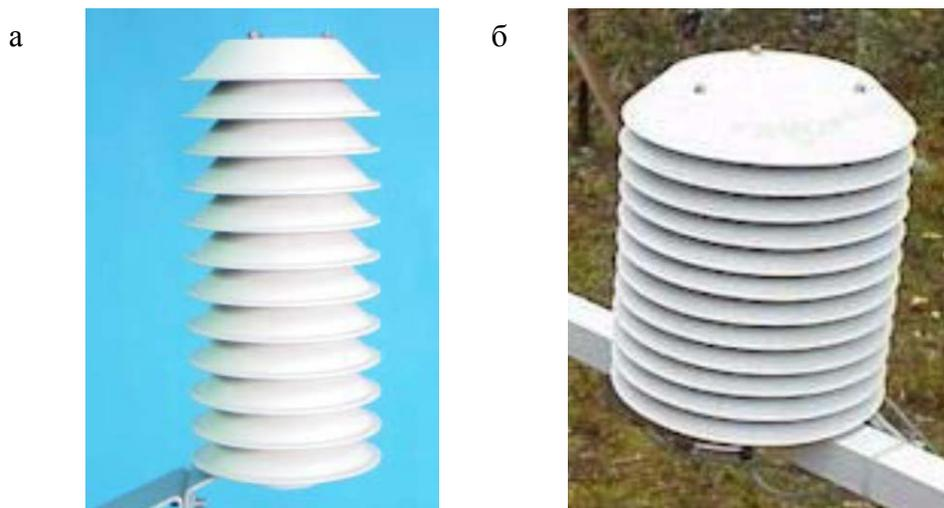
Рисунок 8.2 – Радиационная защита DTR 502 (а) и DTR 13 (б)
