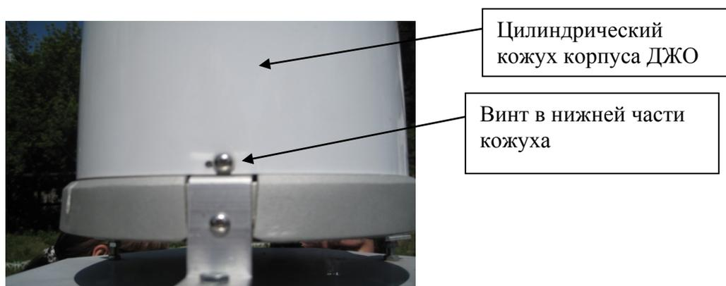
Рисунок 10.7 – Расположение винтов на корпусе ДЖО
